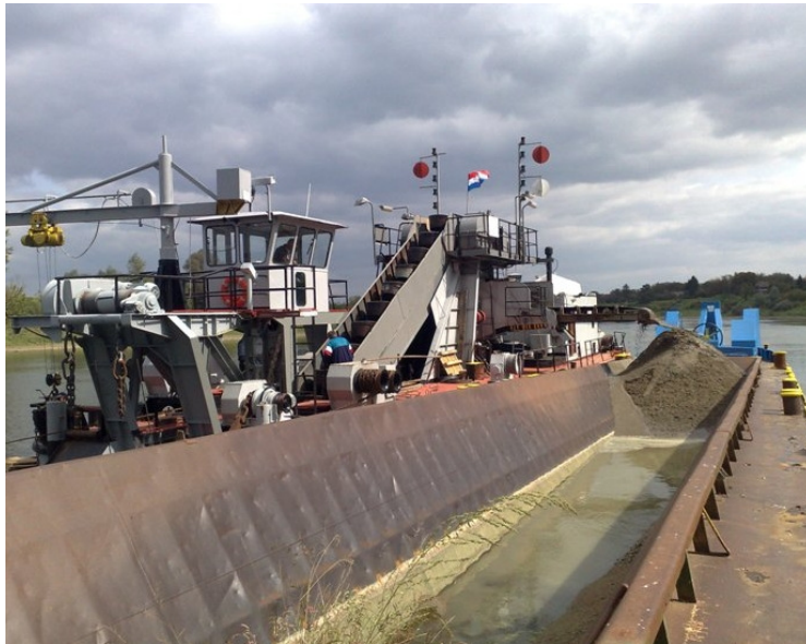
Slika 2.4.3.-1. Barža sa pokretnim dnom za prijevoz kamenog materijala
