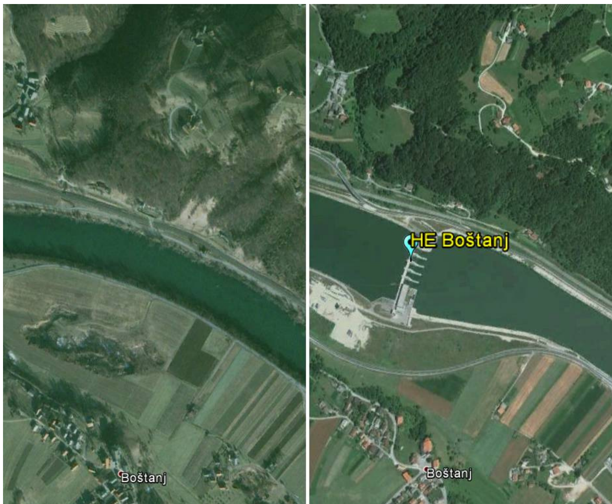
Slika 3. Korito rijeke Save prije i nakon izgradnje HE Boštanj
